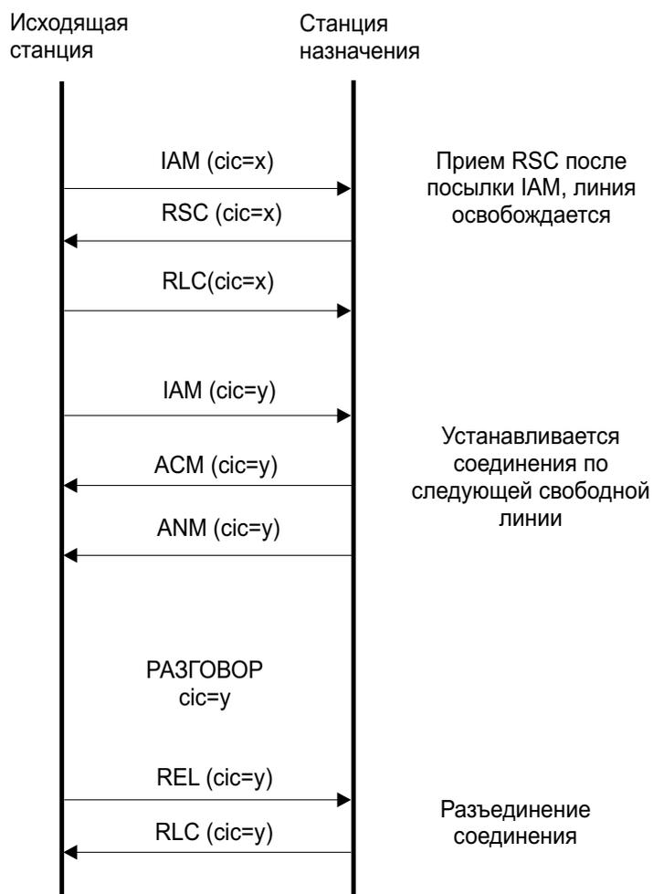
Рис. 14: Автоматическая попытка повторения вызова при приеме RSC после посылки IAM
