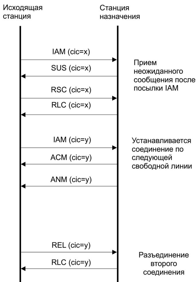
Рис. 23: Автоматическое повторение попытки установления вызова из-за приема неожиданного сообщения
