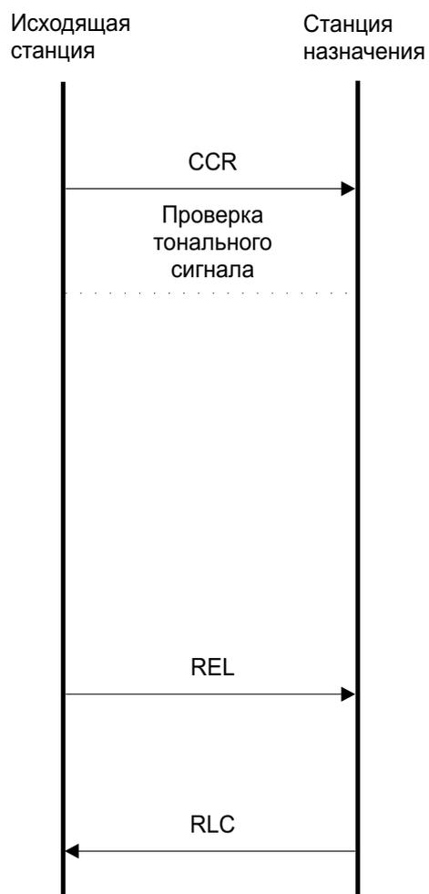
Рис. 21: Успешная проверка непрерывности на свободной линии
